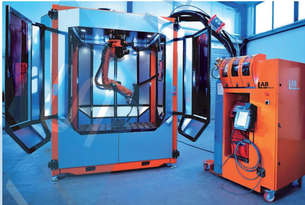
Die LAB-Kompaktzelle: Durch die Positionierung des Roboters an der Decke der Zelle wird eine optimale Ausnutzung der Fläche erreicht (Bild: LAW-weld)
